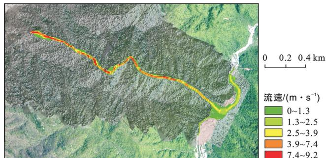
图 7 鸡窝子山洪泥石流流深和流速分布
