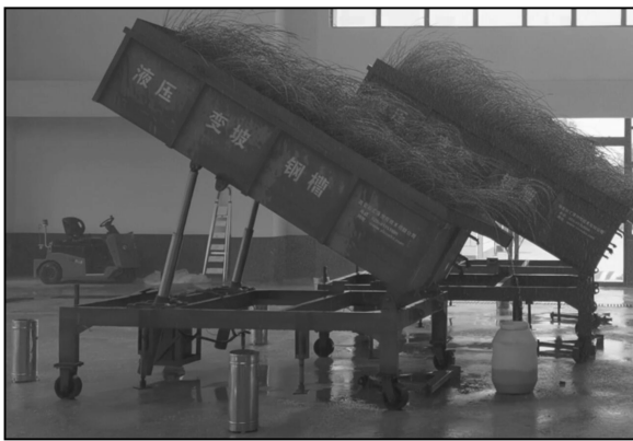
图 2 试验设备钢槽车示意图和实物图
