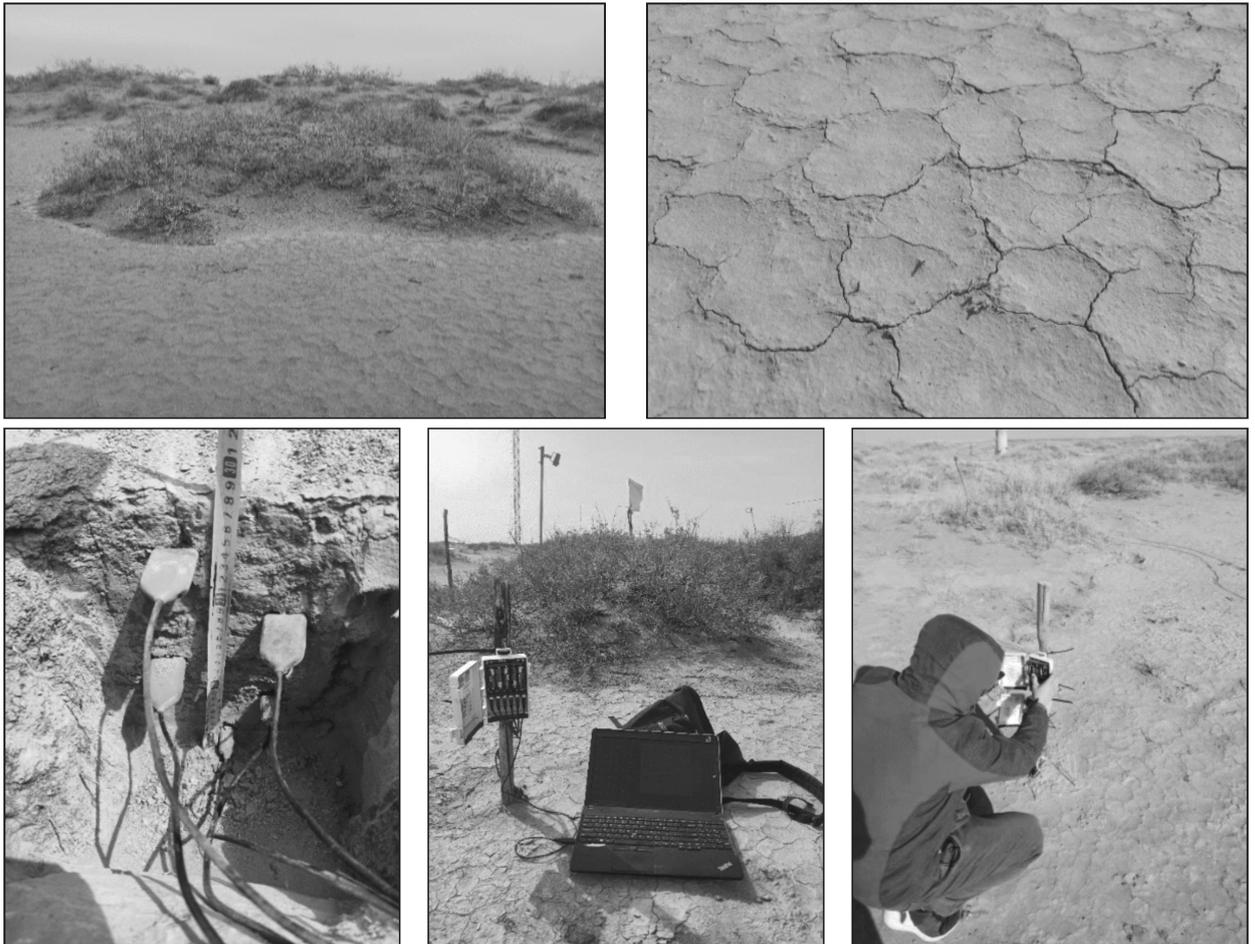
图1 丘间地黏土层景观及土壤水分传感器安装
