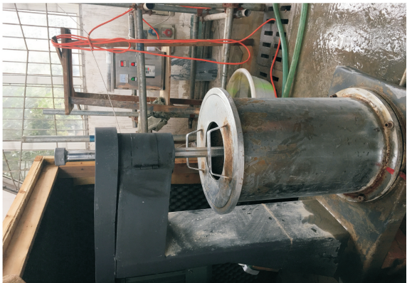
图 5 水下钢球法试验装置
