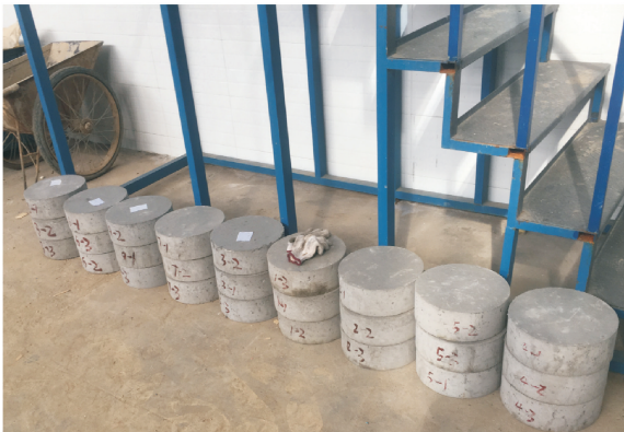
图 4 完成养护待冲磨的 9 组试件
