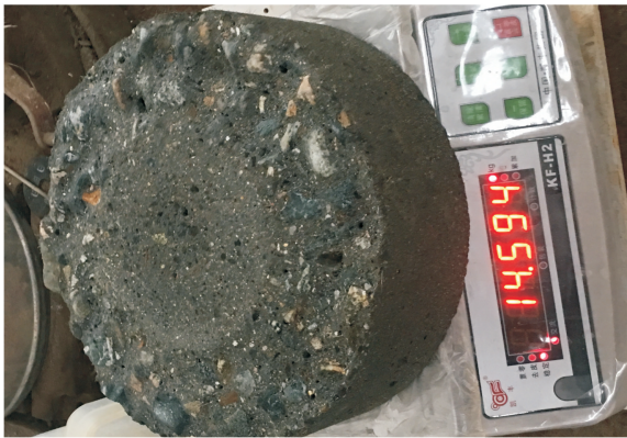
图 6 经历 12 h 冲磨试验的一个试件
