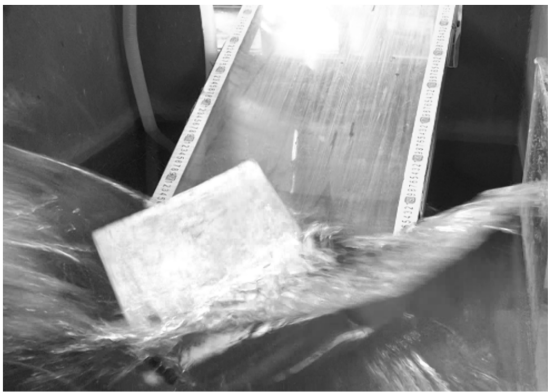
图 4 滑块入水瞬间的水体飞溅现象
