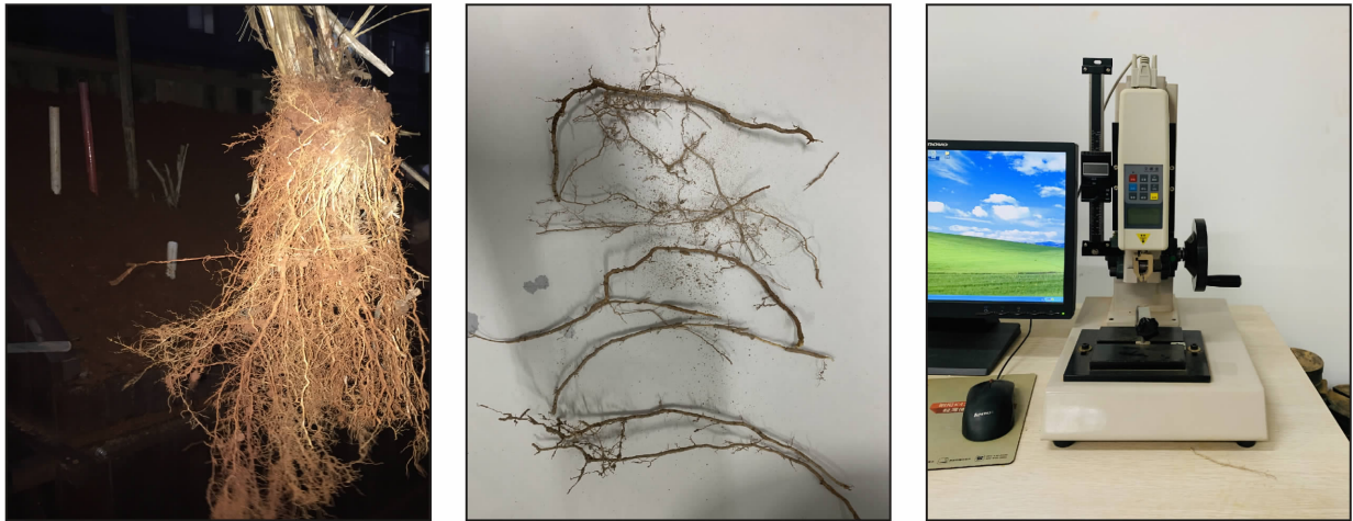
图 1 香根草根系取样及拉拔试验
