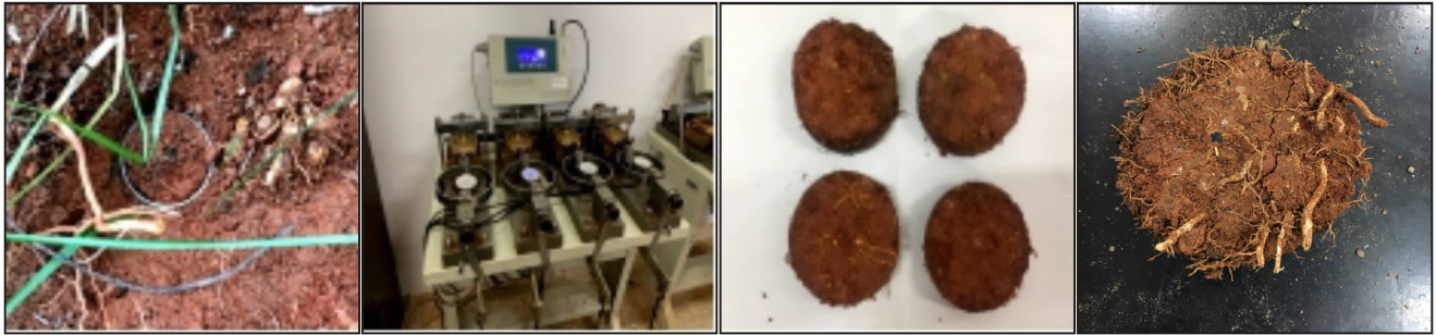
图 3 香根草根土复合体取样及直剪试验
