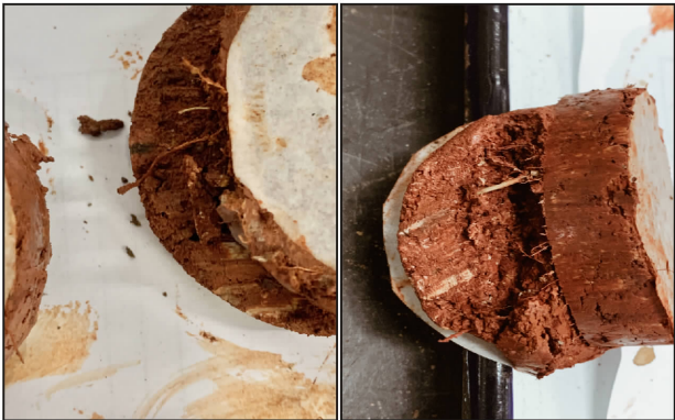
图 5 直剪试验后的香根草根土复合体样本
