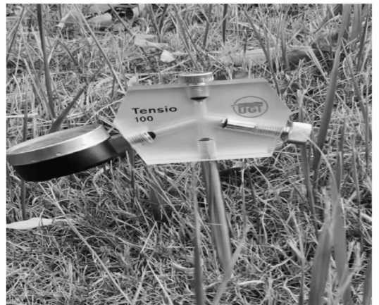
图 2 采用 UGT 张力计测试现场
