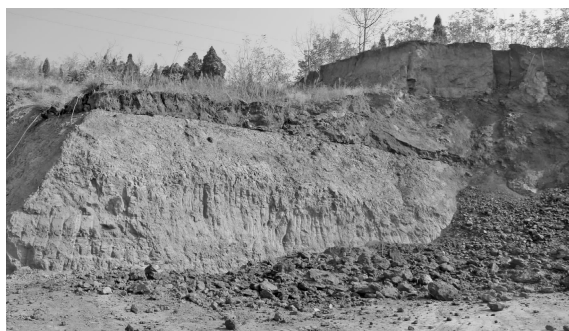
图 2 山阳中学滑坡中部平台开挖出露次级滑带
