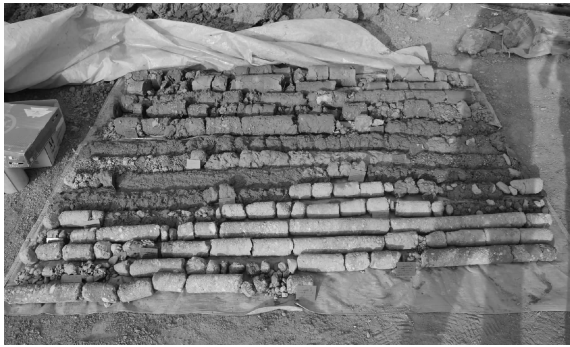
图 4 山阳中学 ZK2 钻孔岩芯编录
