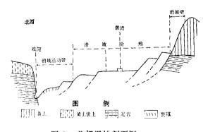
图 4 黄坪滑坡剖面图
