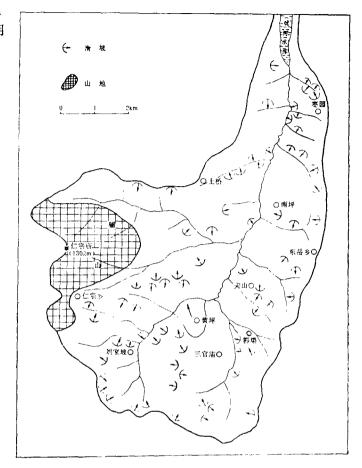
图 3 戏河上游滑坡分布图
