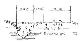
图 1 陇东黄土高原沟道小流域横剖面示意图
